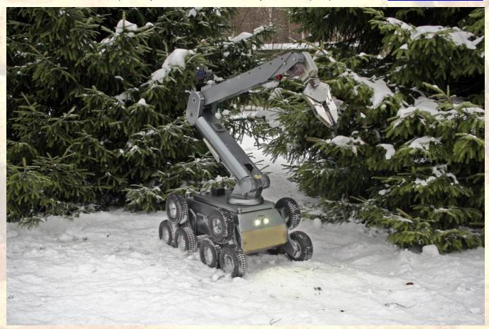
Мобильный робототехнический комплекс (МРК) «Тайфун» состоит из «Колесно-шагающего» транспортного средства, телевизионной (тепло-телевизионной) системы видеонаблюдения, пульта дистанционного управления, манипулятора и/или другого дополнительного оборудования.
